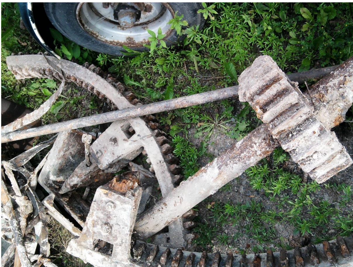
Nalezené zbytky palečného soukolí z původního strojního vybavení ( ocelový věnec z velkého palečného kola s naklínovanými dubovými palci + ocelový pastorek
