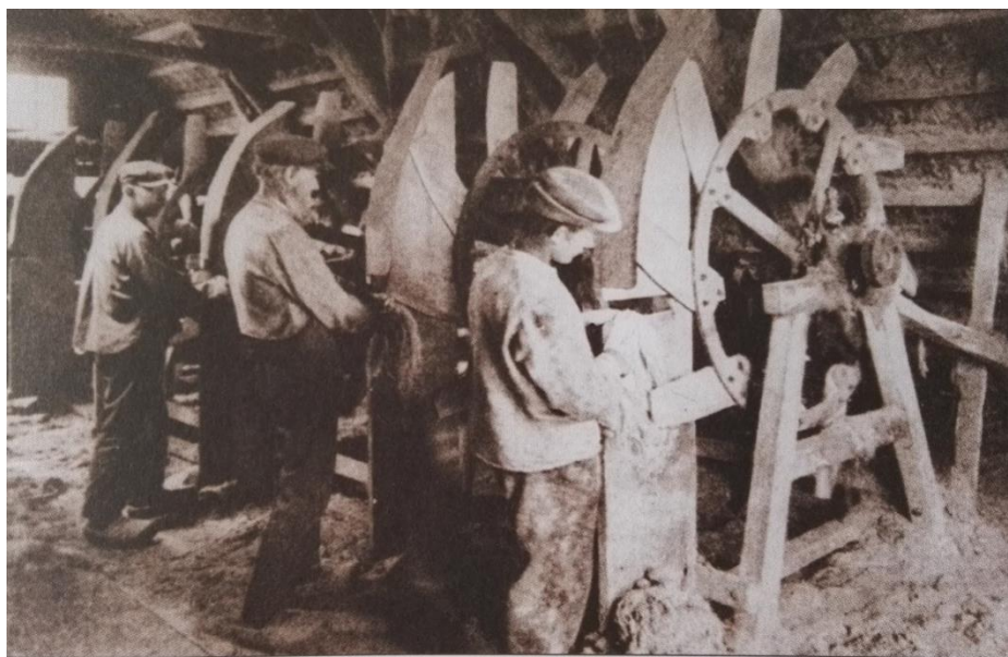
Ukázka práce na tzv vlámské potěračce v tírně kdesi v západní evropě na přelomu 19/20století. Fotografie z knihy Dílo mlynářů a sekerníků v čechách
