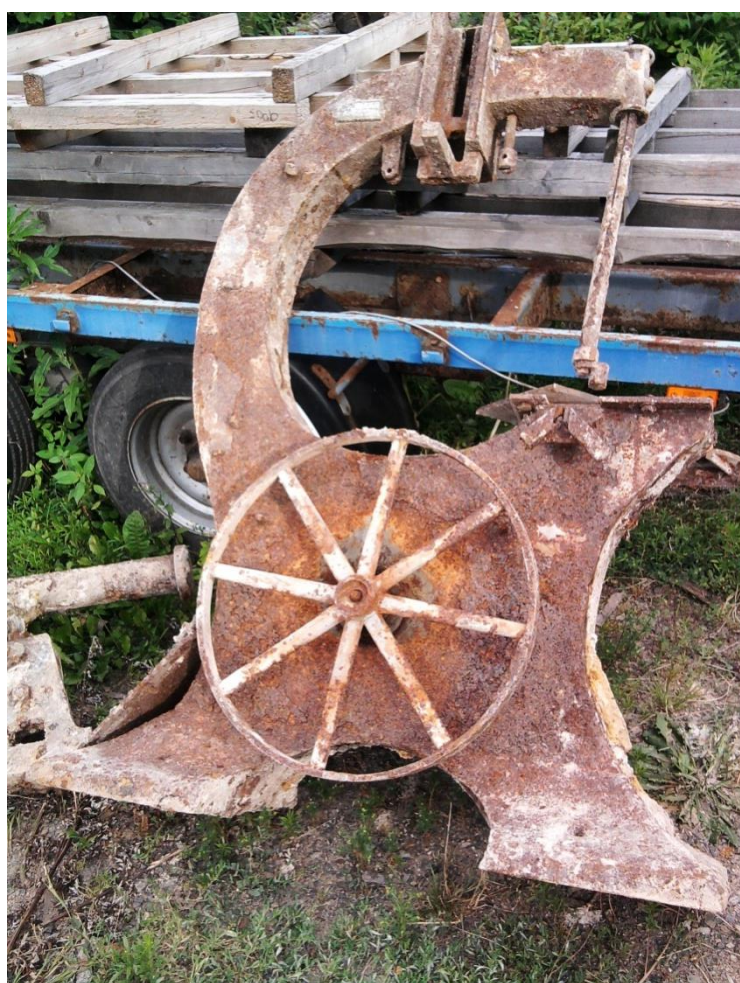
Nalezený rám pásové pily z původního strojního vybavení
