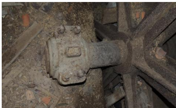
Vlevo detail spoje dvojdílného velkého převodového kola, vpravo detail kluzného ložiska hnacího hřídele
