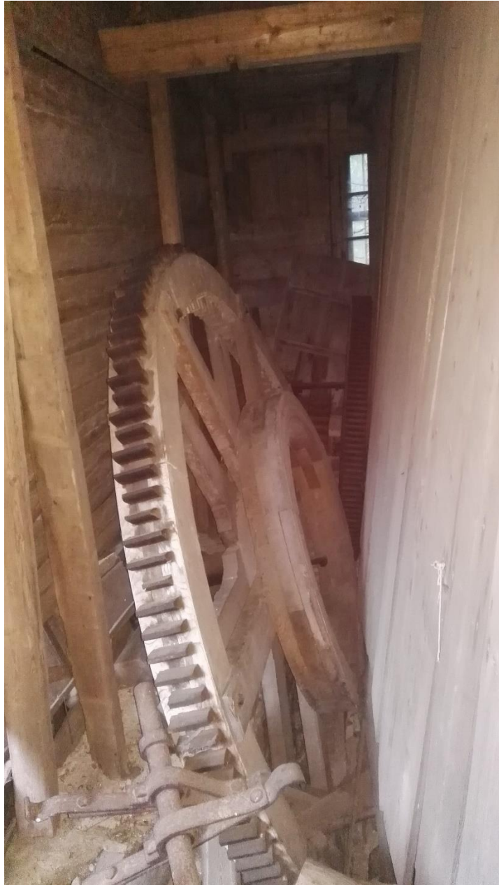
Pohled do převodového prostoru -vpředu palečné kolo s připevněnou dřevěnou řemenicí k pohonu stoupy, v pozadí ocelové převodové soukolí
