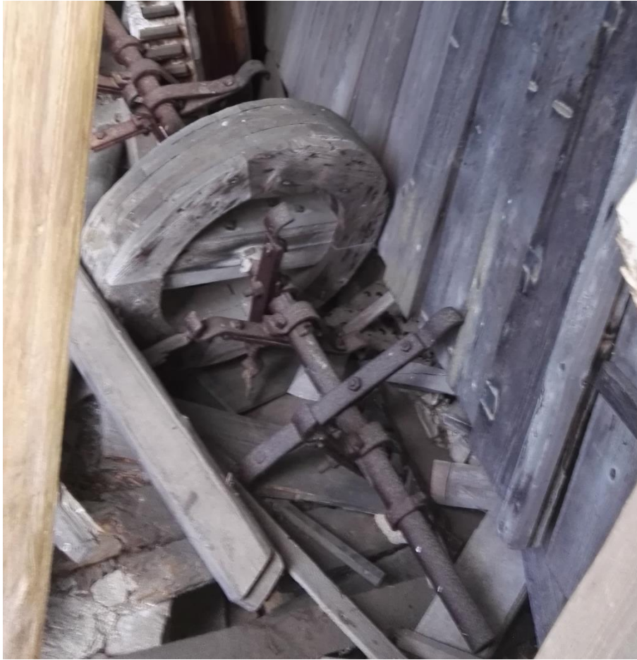
Převodový prostor-detail hřídele pohonu tyčové stoupy, který se volně válí na zemi
