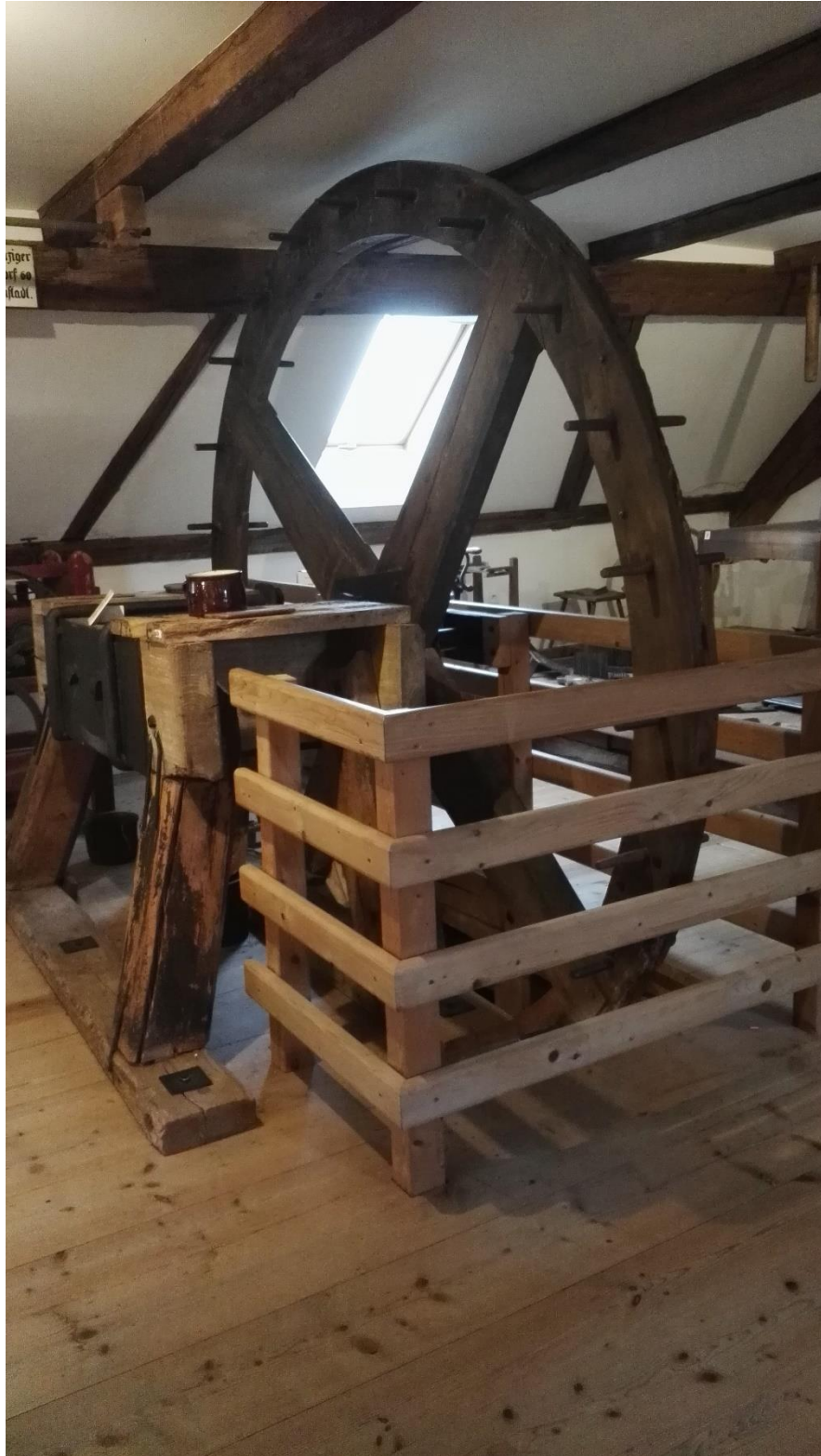
Ruční šroubový lis, který se původně nacházel ve velké místnosti olejny-dnes umístěný v expozici muzea řemesel v Letohradě
