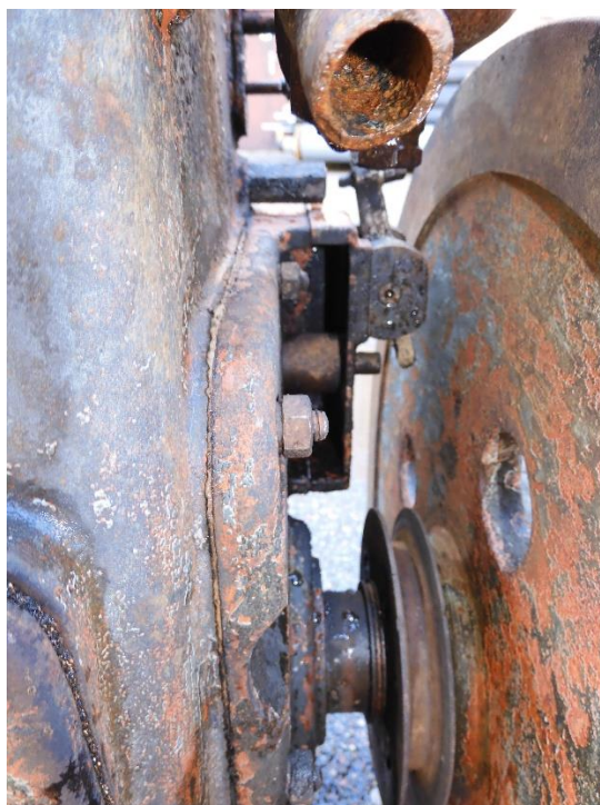
Větší detail soustavy ovládací páky z druhé strany. Je na něm vidět konec vačkového hřídele jehož středem prochází tlačný čep regulátoru, který působí na dvouramennou regulační páku vstřikovacího čerpadla
