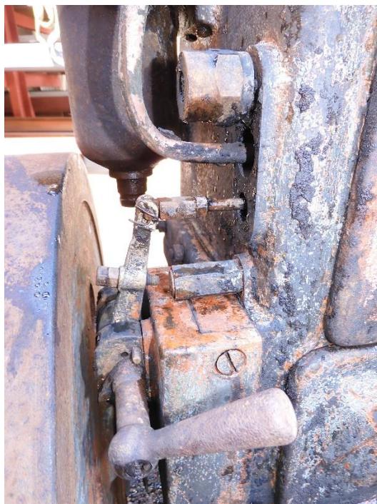
Detail soustavy ovládací páky vstřikovacího čerpadla a její nastavitelný doraz
