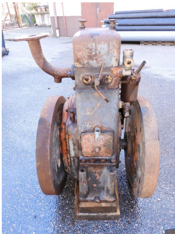
Celkový pohled na dochovaný motor. V hlavě je vidět zašroubovaný žhavicí šroub. Pod ním další servisní víko pro přístup do klikové skříně
